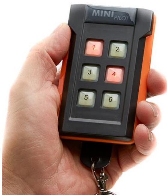
L'émetteur dispose de 6 boutons rétro-éclairés, qui peuvent le statut du relais. Selon le programme, les touches possèdent des fonctions différentes ou différentes fonctions de relais sont mises en route.
